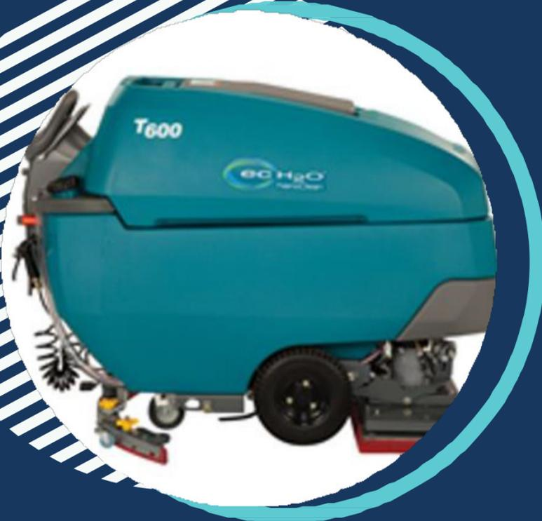
Surgem como solução para obtenção de grande produtividade na execução de atividades conjuntas em um mesmo equipamento pois as mesmas esfregam, limpam, fazem a sucção do resíduo de limpeza do piso e secam em uma única operação, causando baixa interferência no tráfego local e proporcionando uma lavagem rápida de pequenas e grandes áreas com pisos regulares e nivelados (shopping centers, estacionamentos, etc.). Uma máquina dessas equivale à produtividade de 6 pessoas na mesma execução do trabalho.
