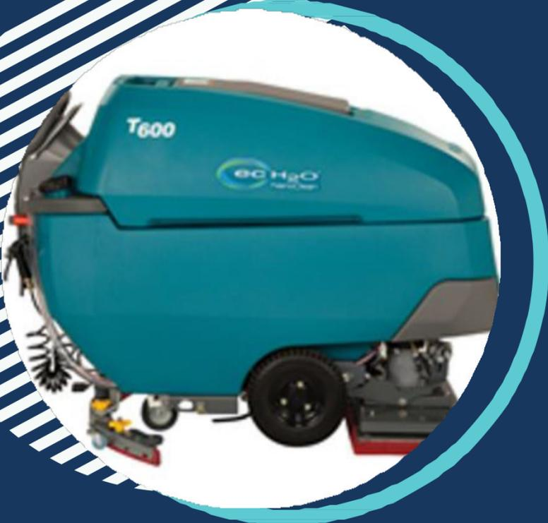
Existem equipamentos que são monofuncionais e equipamentos multifuncionais e sua operação se baseia no processo onde a solução detergente é armazenada no reservatório chamado de “água limpa” e, por gravidade ou válvula, a solução é disparada no piso e os discos ou escovas atuam retirando a sujidade e o sistema de sucção aspira a água suja depositando-a em outro reservatório chamado de “água suja” devendo esta ser descartada posteriormente em local apropriado.
